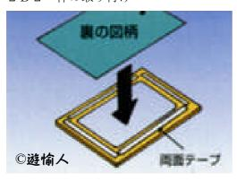
枠の片面に両面テープを貼り、台などの上に広げたフィルムに 押し付けます。
