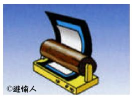
露光器を開けて下からホルダー(黒)、シルクスクリーンフィルム、 原稿の順に重ねて巻き、しっかりと止めます。 フィルムと原稿をぴったりと密着させてください。 (密着しないと版の輪郭がぼやけます)
