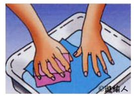
シルクスクリーンフィルムを原稿から外し、バット(容器)に 入れて水洗いします。
