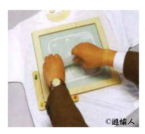
シルクスクリーンスタートキットをお買い上げの方は、 パネルハンガーを使って、版をTシャツなどの印刷したい 素材に固定します。
