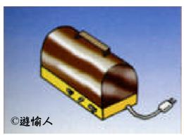
露光器のフタを閉めてスイッチを入れて露光します。 露光時間の目安 (原稿の紙種による目安です) 白い紙=約2~3分 トレーシングペーパー=約90秒 OHPフィルム=約60秒
